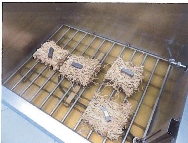
Figura 6: Determinação da absorção de água por imersão parcial de curta duração dos provetes de fardos de palha de arroz.
