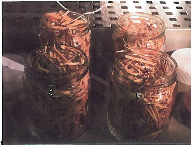
Figura 9: Ensaio de determinação das curvas higroscópicas da palha de arroz.
