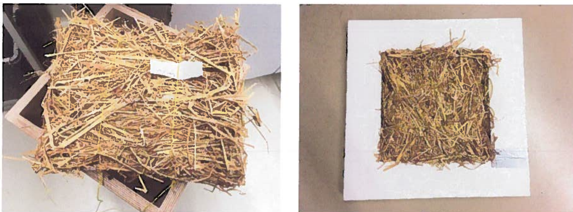
Figura 7: Preparação de provetes para a determinação do coeficiente de condutibilidade térmica dos fardos de palha de arroz.
