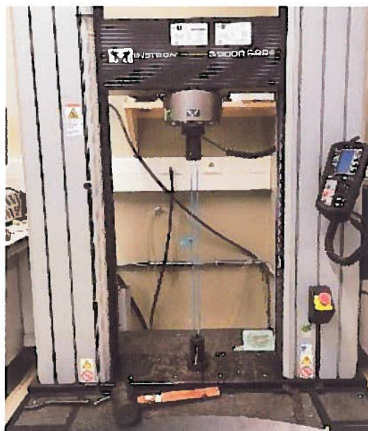
Figura 17: Ensaio de resistência à tração dos cordões.
