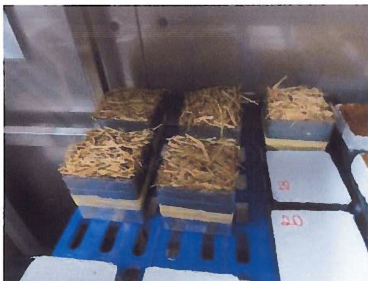
Figura 8: Ensaio de determinação das propriedades de transmissão do vapor de água.
