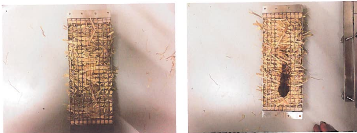
Figura 15: Provete de palha de arroz antes (à esquerda) e depois (à direita) do ensaio de ignitabilidade.
